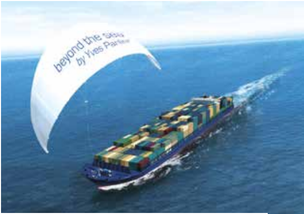
Le projet Beyond the Sea vise à développer une technologie spécialisée de kites pour tracter les navires
